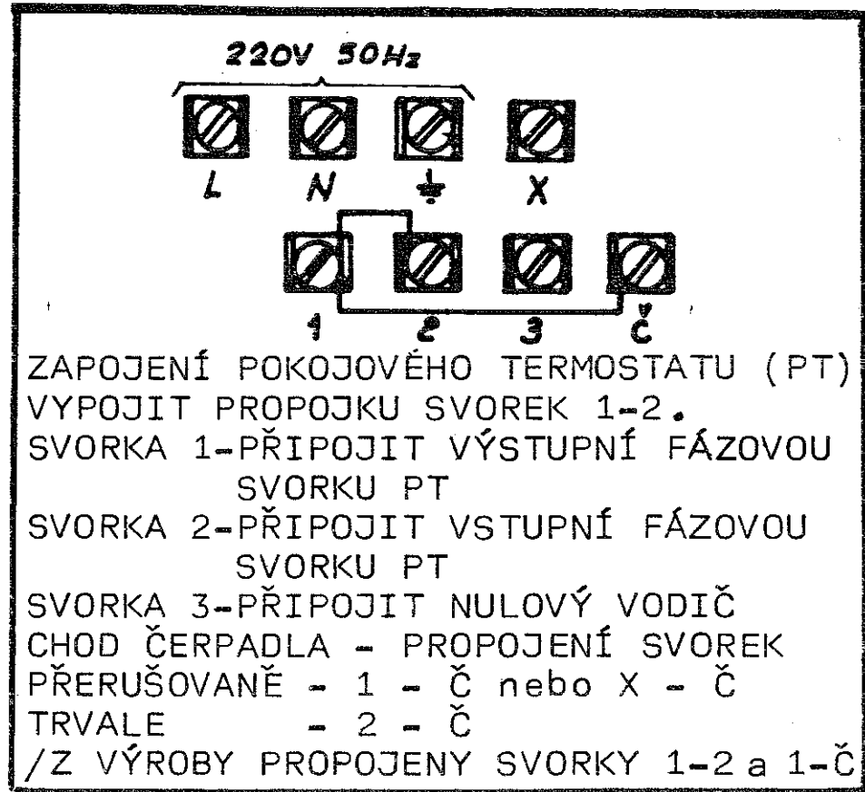
Obr. 13.: Schema zapojení svorkovnice
